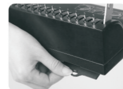
Мал. 8 Очистіть лоток від відпрацьованого матеріалу.
