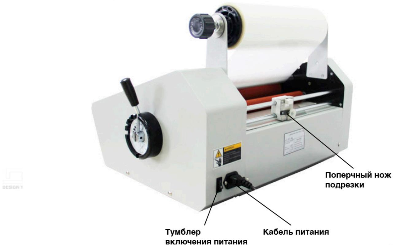
**Внимание!** Во избежание преждевременного износа редукторов, электроугольных щеток, электродвигателя или других электронных элементов, не оставляйте ламинатор включенным более, чем на 4 часа. Также через каждые 4 часа непрерывной работы необходимо выключать ламинатор прим. на 30мин. В случае кратковременной остановки, снизьте температуру до 80° и обязательно разожмите горячие валы, это продлит ресурс работы ламинатора и сохранность покрытия горячих валов.
